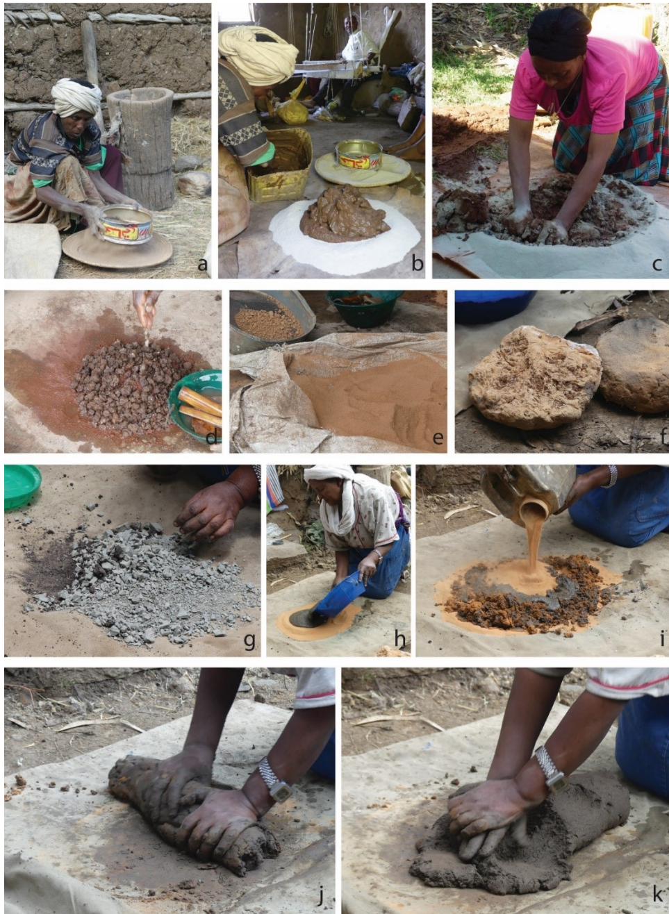
Fig. 3.53. Les procédés de préparation de l'argile au sein de la tradition F : a) Tamisage de l'argile rouge à l'aide d'un tamis à farine suite au concassage réalisé au pilon et mortier visibles en arrière-plan, par Fesses, potière Amhara du monastère de Menteq ; b) Argile rouge préalablement hydratée par immersion, déposée au centre d'un tas d'argile pour une hydratation par imprégnation au fur et à mesure du pétrissage ; c) Pétrissage par une potière Oromo Shewa du village de Qersa ; d) Hydratation du matériau argileux rouge par humectation, par Yemeneshu, potière Amhara du village de Zego ; e) Chamotte de granulométrie fine préparée à partir de tessons de céramique concassés au pilon et mortier, puis tamisés ; f) Pain d'argile rouge grossièrement préparé et cuit avant d'être réduit en une granulométrie fine, chez Mimi, potière Amhara du monastère de Muger ; g) Les deux matériaux argileux noir et gris dont les racines et cailloux sont retirés avant d'être immergés dans l'eau, à Muger ; h), i) Matériau argileux préalablement hydraté par immersion, déposé au centre sur l'argile rouge réduite à granulométrie fine pour une hydratation par imprégnation au fur et à mesure du pétrissage ; j), k) Pétrissage, une fois la galette écrasée, la potière l'enroule sur elle-même pour former un pâton cylindrique qu'elle dispose à nouveau devant elle pour reprendre les pressions de pétrissage effectuées par les poignets, paumes et doigts des mains jointes.
