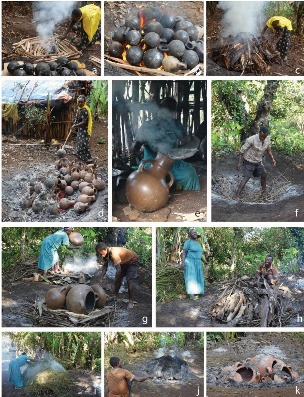
Fig. 3.14. Les procédés de cuisson au sein de la tradition A. Chez Messeret, potière Oromo Guji du village de Manitu : a) Installation du bois d'eucalyptus en un lit circulaire ; b) Disposition des cafetières à cuire selon un agencement circulaire avec empilement, les cols sont tournés vers le centre de la cuisson ; c) La potière recouvre le tas de cafetières avec le combustible léger fait de feuilles d'ensete sèches ; d) Manipulation des céramiques cuites à la fin de la cuisson, celles qui sont assez cuites sont posées sur le côté de l'aire de cuisson, tandis que les autres sont laissées encore quelques minutes dans les braises incandescentes. Chez Baro, potière Aari du village de Yetnebersh : a) Pré-cuisson réalisée en disposant les récipients près d'un feu et en insérant des braises incandescentes ; b) Belay, mari de Baro, dans l'aire de cuisson, installe le premier lit de bois fait de branchages de caféiers ; c) Disposition des récipients à cuire ; h), i) Les récipients sont recouverts de bois, puis d'herbe ; j) Contrôle de la température de cuisson en vérifiant que tous les pots sont rougis ; k) A la fin de la cuisson, les cendres sont progressivement retirées du tas de céramiques.
