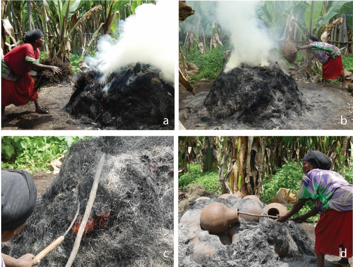
Fig. 3.22. Les procédés de cuisson au sein de la tradition B : a) Les potières ajoutent du combustible léger au fur et à mesure de la cuisson ; b) Les potières rejettent les cendres de l'herbe brûlée tombant alentour sur la structure de cuisson ; c) Contrôle de la température pour s'assurer que les pots sont rougis ; d) Retrait des céramiques brûlantes après cuisson.
