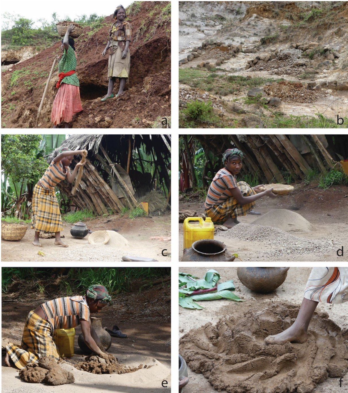
Fig. 3.5. Les procédés de préparation de l'argile au sein de la tradition A. Chez les potières Yem du village de Boloji : a) Après avoir extrait l'argile rouge en fosse à l'aide d'un pic en métal emmanché sur un long manche en bois, les potières la disposent dans un panier en bambou qu'elles portent sur leur tête ; b) A proximité des sources d'argile, des emplacements de séchage délimités par des alignements de pierre, sont réservés pour chaque famille de potiers ; c) Zeritu, apprentie potière Yem du village de Boloji prépare l'argile qui sera principalement employée par sa mère. L'opération de concassage se fait à l'aide d'un battoir en bois réservé à cet effet, selon une gestuelle rotative faisant passer le battoir dans le dos de la potière qui l'abat ensuite de toutes ses forces sur le tas d'argile sèche répandu au sol ; d) L'opération de tamisage se fait à l'aide d'un tamis végétal dont le reflux sera réintégré à l'argile attendant d'être concassée ; e) L'opération d'hydratation est réalisée par humectation et imprégnation à partir d'un puits d'eau. Un premier pétrissage permet de former des pâtons de taille moyenne ; f) La seconde étape du pétrissage est réalisée au pied une fois les pâtons réunis en une importante masse d'argile, la potière la foule de son pied droit en tournant autour.
