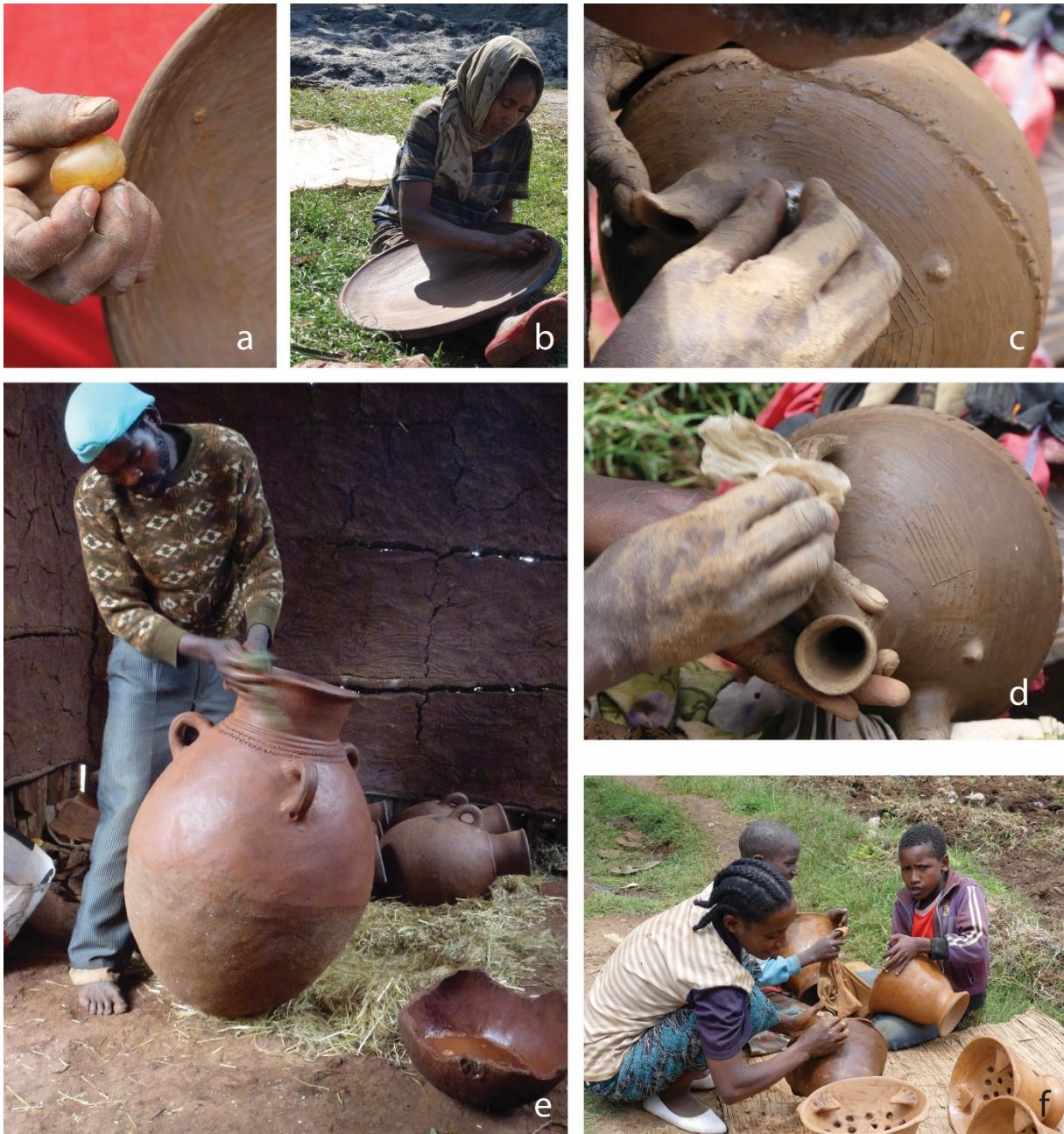
Fig. 3.29. Techniques de traitement de surface employées au sein de la tradition C. Brunissage à l'aide d'un galet de pierre au grain fin : a) potière Kambata à Bobicho, b) potière Wolayta à Goljoota ; c) Brunissage effectué à l'aide d'une bille en métal par une potière Kambata à Bobicho ; d) Lustrage à l'aide d'une petite pièce de sac plastique suite au brunissage ; e) Engobage de la partie supérieure d'une jarre de grande taille par le mari d'Aberash, potière Wolayta à Goljota ; f) Engobage et lustrage des braséros par une potière Kambata.
