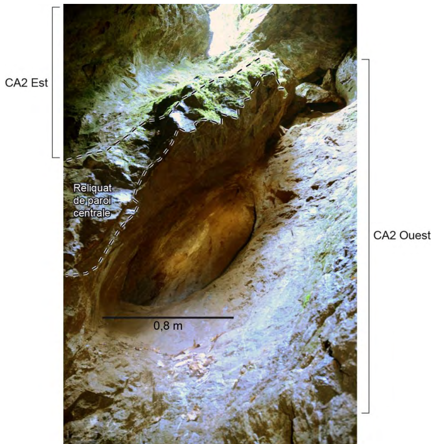
Fig. 93 : Mine de La Coustalade : vue de la moitié ouest du chantier CA2, à l'étage -6,5, vers le sud. On observe également les veines parallèles au filon n°1 visibles en blanc sur le front de taille et sur le parement est.
