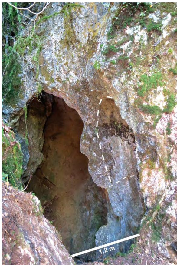
a. Négatif de coupole dans la partie supérieure du chantier CA2 Est.
