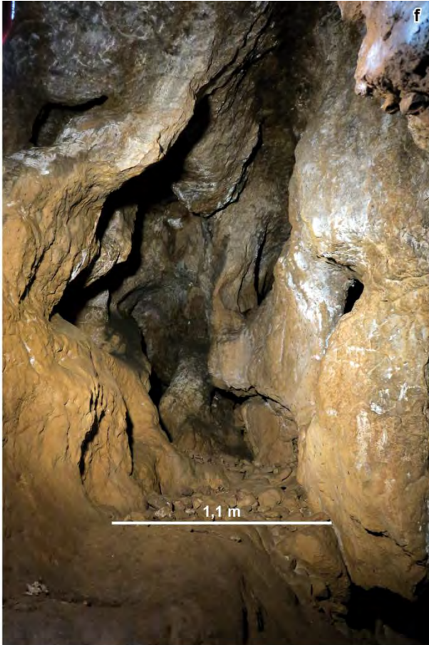
f. Chantier irrégulier formé par l'accumulation d'ouvertures de petit volume, correspondant à différents étages d'exploitation, vu vers le sud. Cette morphologie est liée à celle de la minéralisation et peut résulter d'une seule phase d'activité.
