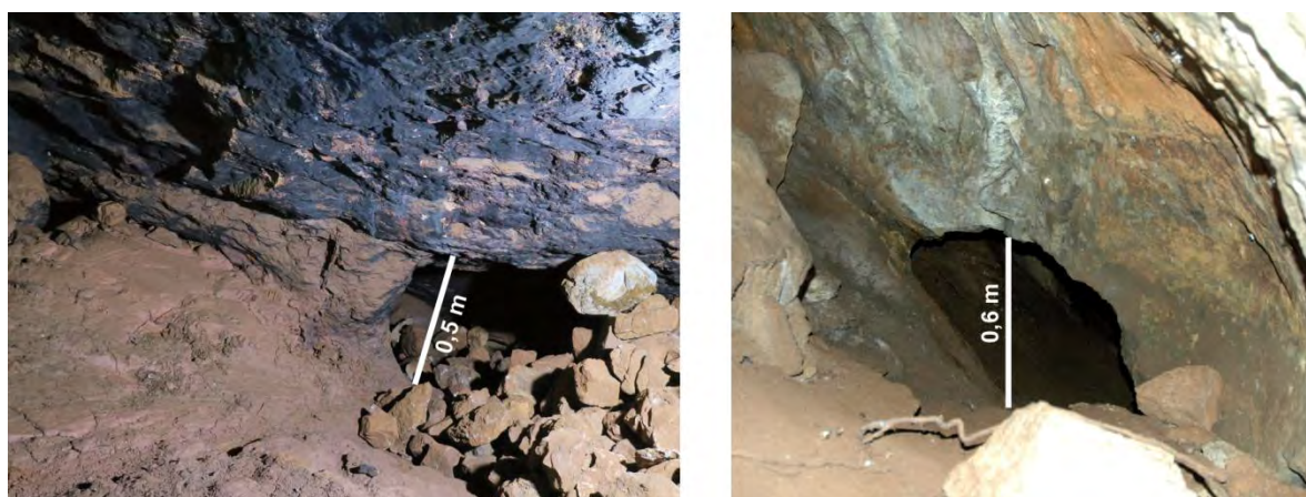
Fig. 174 : Piliers de roche entre deux étages d'exploitation à Hautech 16 (gauche) et Rougé (droite).
