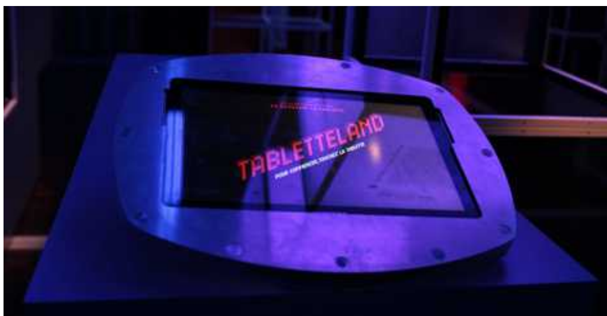
Illustration 17: une des tablettes de l'installation Tabletteland, maintenue dans un cadre en acier, et retenue au mobilier par un câble.
