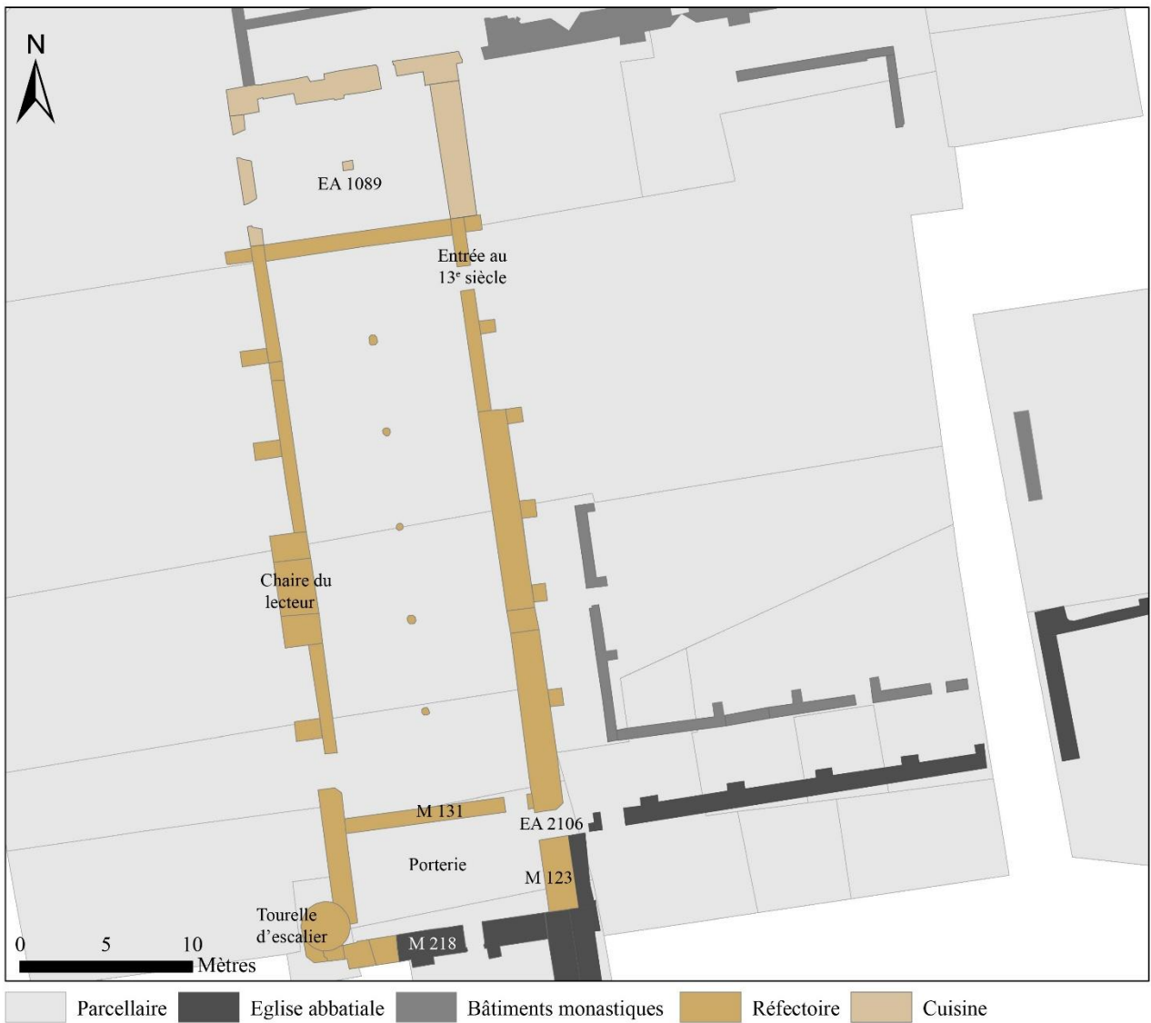
Illustration 7.27 – Plan de l’aile occidentale du cloître de Cormery : la porterie, le réfectoire et les cuisines.
