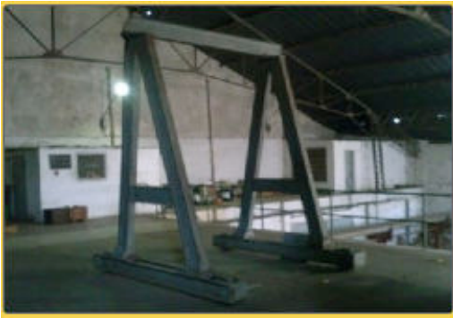
Potence d'entretien turbines SAUTTER
