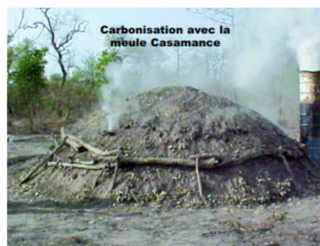
Production de charbon de bois au Sénégal par technique de la "meule Casamance"
