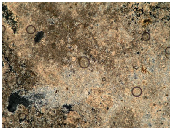
Aspect général du liant finement cristallisé avec parfois l'évolution de la structure vers un gel (zones brun foncé) – G : 100
