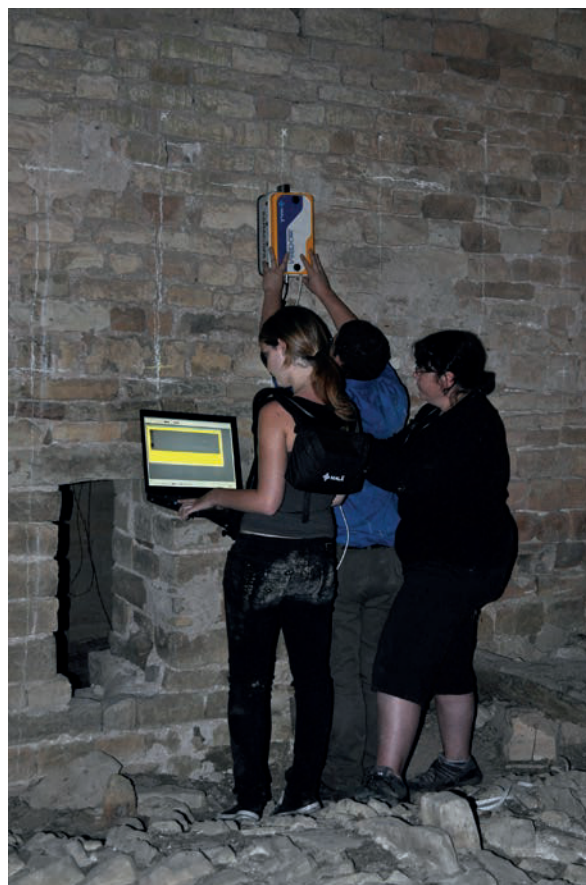
Fig. 39 – Relevé radar sur la maçonnerie du clocher (cliché Cédric Moulis).
