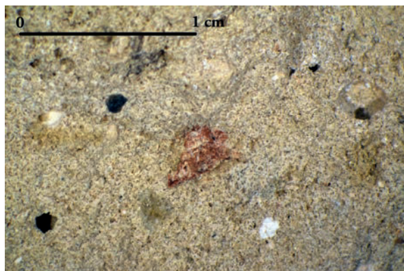
Fig. 43 – Mortier du blocage entre le collatéral et le cloître à la loupe binoculaire (cliché Cédric Moulis).
