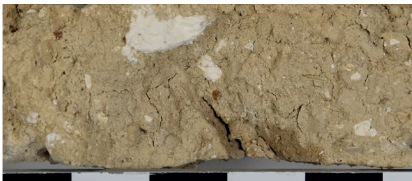
Fig. 14 – Mortier de terre et de nodules de chaux (cliché Cédric Moulis).
