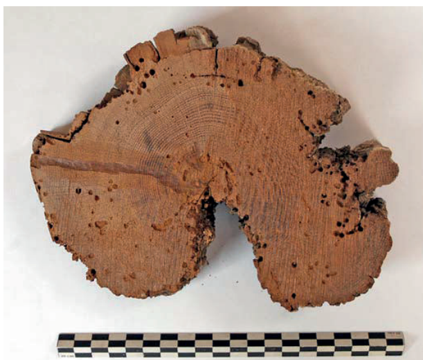
Fig. 1. BLAM001 ; Section transversale de poutre DC1
