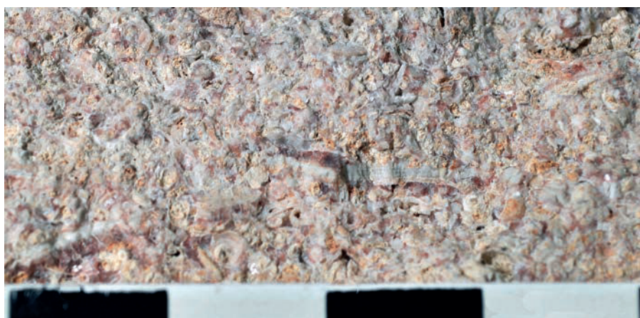
Fig. 43 – Calcaire à Polypiers du Bajocien employé dans la tour (cliché Cédric Moulis).
