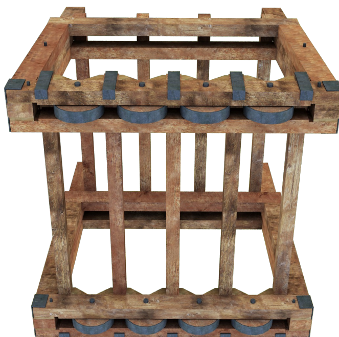
Figure 49 : Emplacement des roues sur la tour d'Apollodore de Damas
