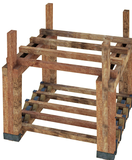
Figure 48 : Quadrillage du haut et du bas de la tour d'Apollodore de Damas
