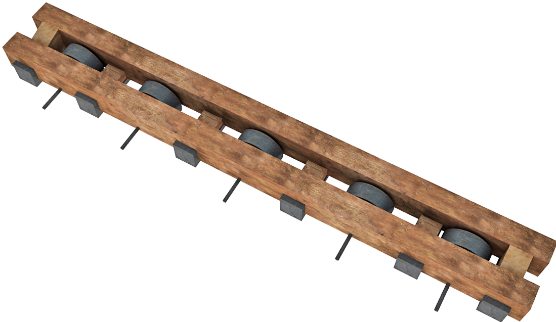
Figure 63 : Système de fixation sur la tortue-bélière
