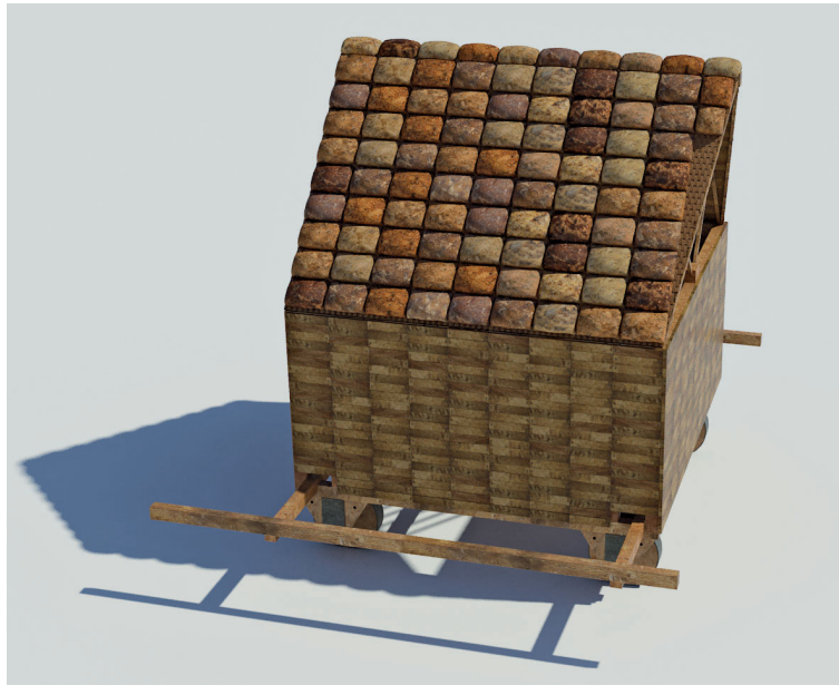
Figure 91 : Hypothèse de restitution de la tortue de mineurs avec auvent (Athénée le Mécanicien)
