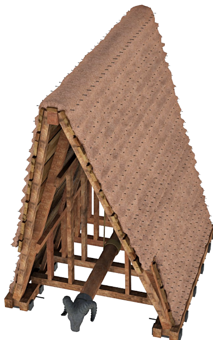
Figure 66 : Hypothèse de restitution de la tortue-bélière d'Apollodore de Damas (vue de face)
