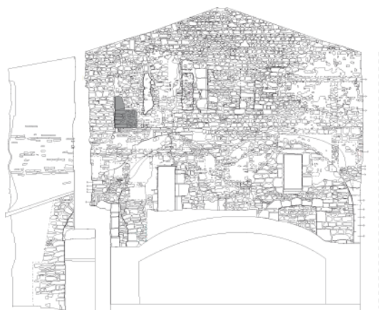
Figure 63. Cuvier, mur sud : localisation de la fenêtre b 15
