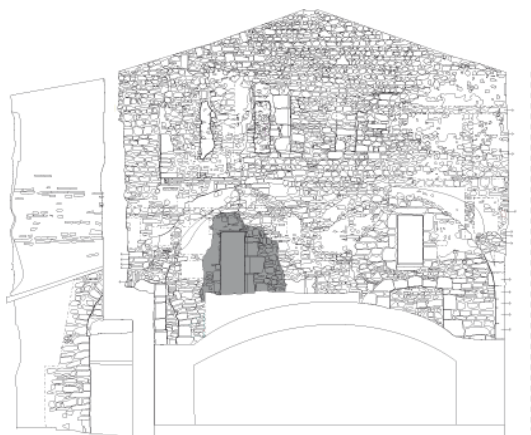
Figure 55 : Cuvier, mur sud : localisation de la porte b 9
