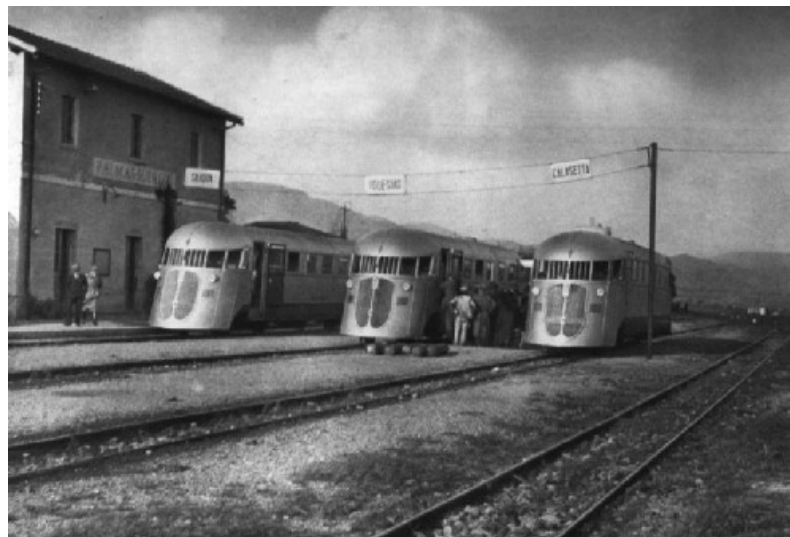
10. Anonyme, Automotrice Alb 48.101 – 103, Fiat, 1932, la première des « Littorine ». Source : Fondazione FS Italiane « Treni storici ». [http://www.fondazionefs.it/ffs/Attivit%C3%A0/Treni-storici]. Consulté le 24 juin 2014.
