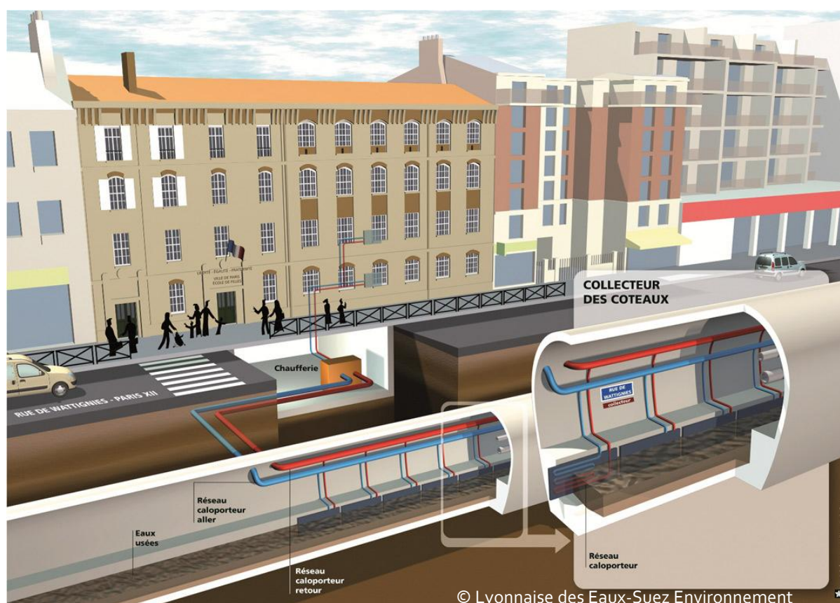
Figure 33. Schéma de fonctionnement du système de récupération de chaleur sur les eaux usées installé rue de Wattignies dans le 12 ème arrondissement de Paris ("Le procédé Degrés Bleus séduit la ville de Paris," 2011)
