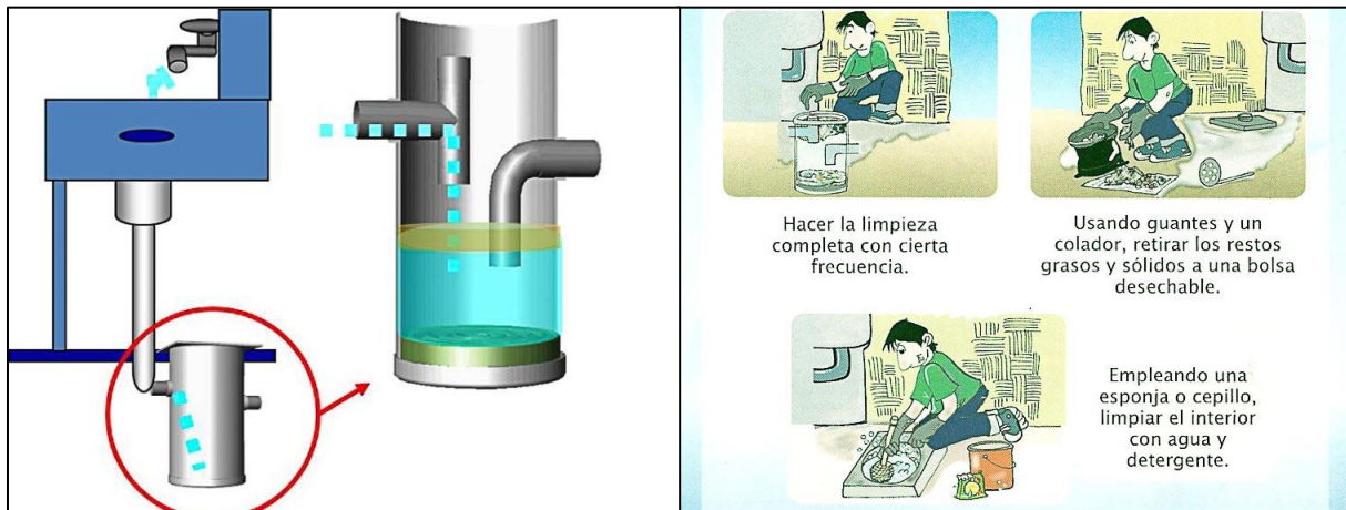
Figure 11/L. Fonctionnement du piège à graisse
