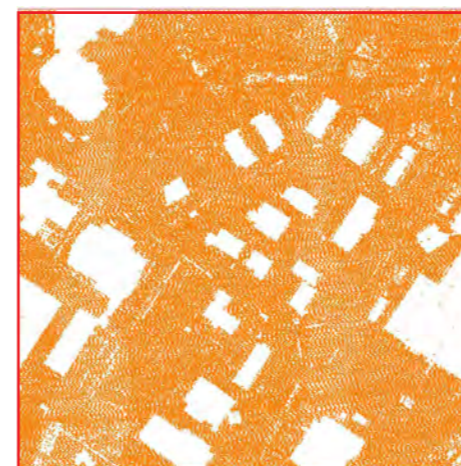
g - Semis de points au sol selon la classification LIEPPEC. L'échantillon contient 1 674 757 points-sol.
