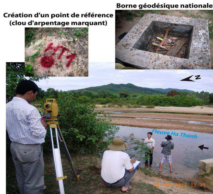
Figure 3.23. Mesure d'altitude par le théodolite (Photographie : Nguyen, H.X., 2012)
