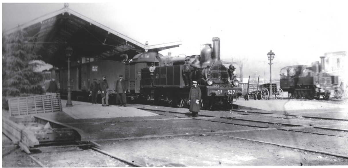
Photographie 29. Locomotive Engerth utilisée sur la ligne du Rhône au Mont-Cenis (photographie prise en 1900 en gare de Chambéry) (collection H. Billiez).
