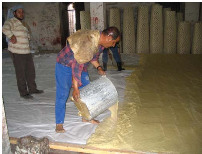
Photo 43. ...puis le savon est versé manuellement
