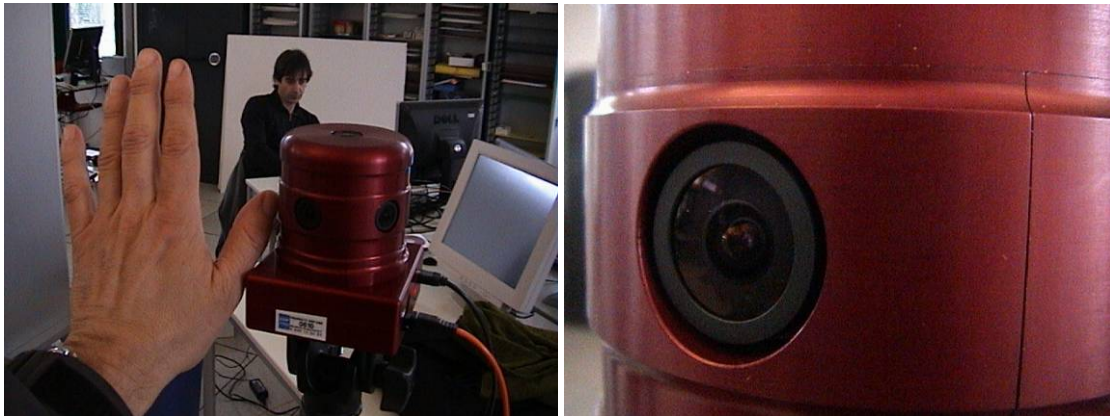
Figure 46 : la caméra panoramique sonore : dispositif de prise de vue avec la camera portable ladybug, constituée de 5 caméras à haute résolution ajustées dans un bloc de métal.
