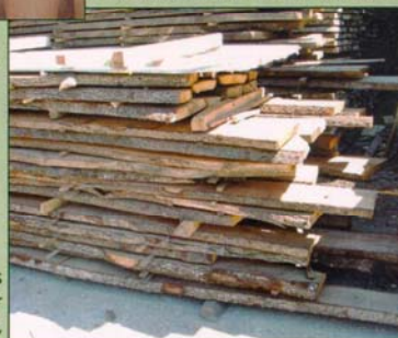
Plateaux en cours de séchage à l'air (Ets Coll Viader, Girona - Espagne).
