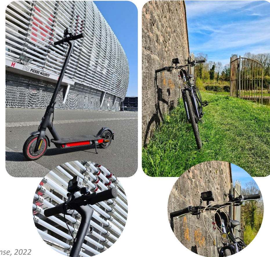
Caméra de marque GoPro installée sur une trottinette et un vélo
