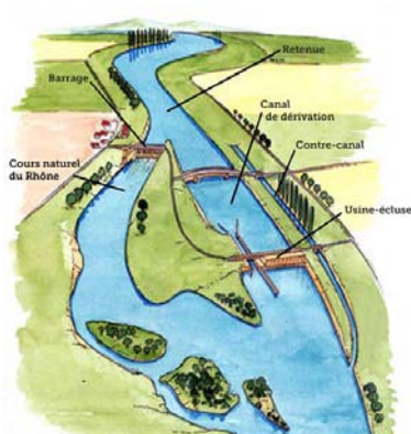
Aménagement hydro-électrique (Source : CNR)
