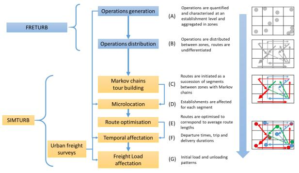
Figure 1 : SIMTURB modelling framework
