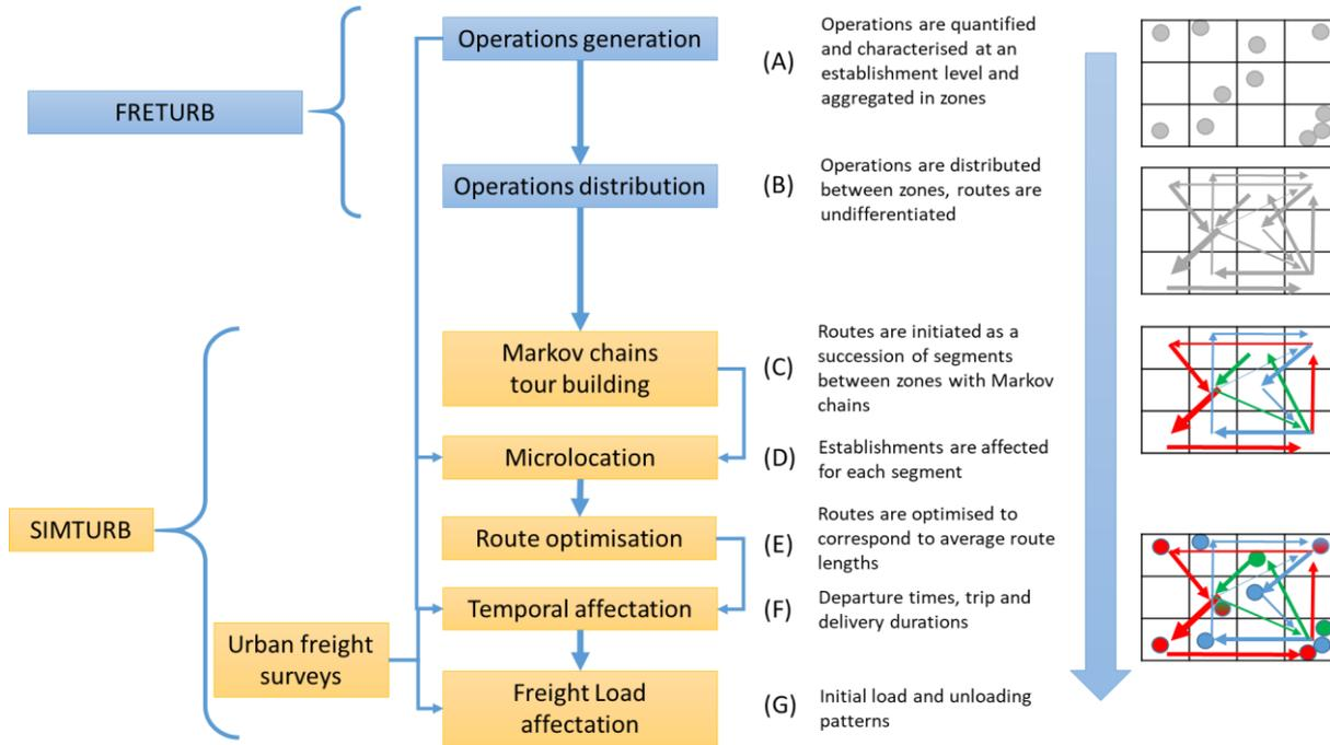
**Figure 1 : SIMUTRB modelling framework**
