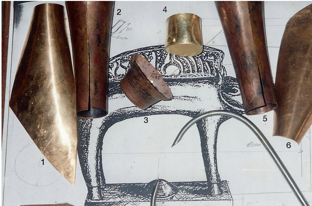
Fig. 7. Pattes et pieds en cours de fabrication ( numéros de gauche à droite ). 1. Flan capable destiné à l'exécution de l'entrejambe de la patte arrière gauche ; 2. Patte avant terminée ; 3. Pied en cours de fabrication ; 4. Pied terminé ; 5. Patte avant terminée ; 6. Flan capable destiné à l'exécution de l'entrejambe de la patte arrière droite (cl. J. Dubos).
