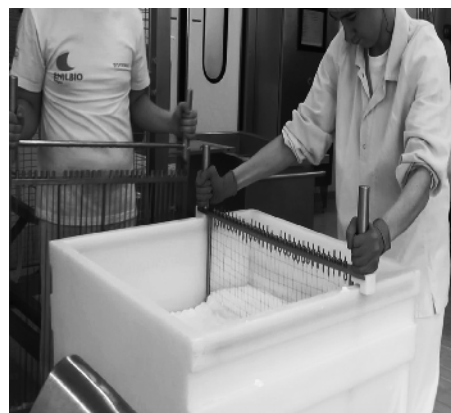
Photo 2 Passage du 2ème tranche-caillé par Martin (matériau A).
