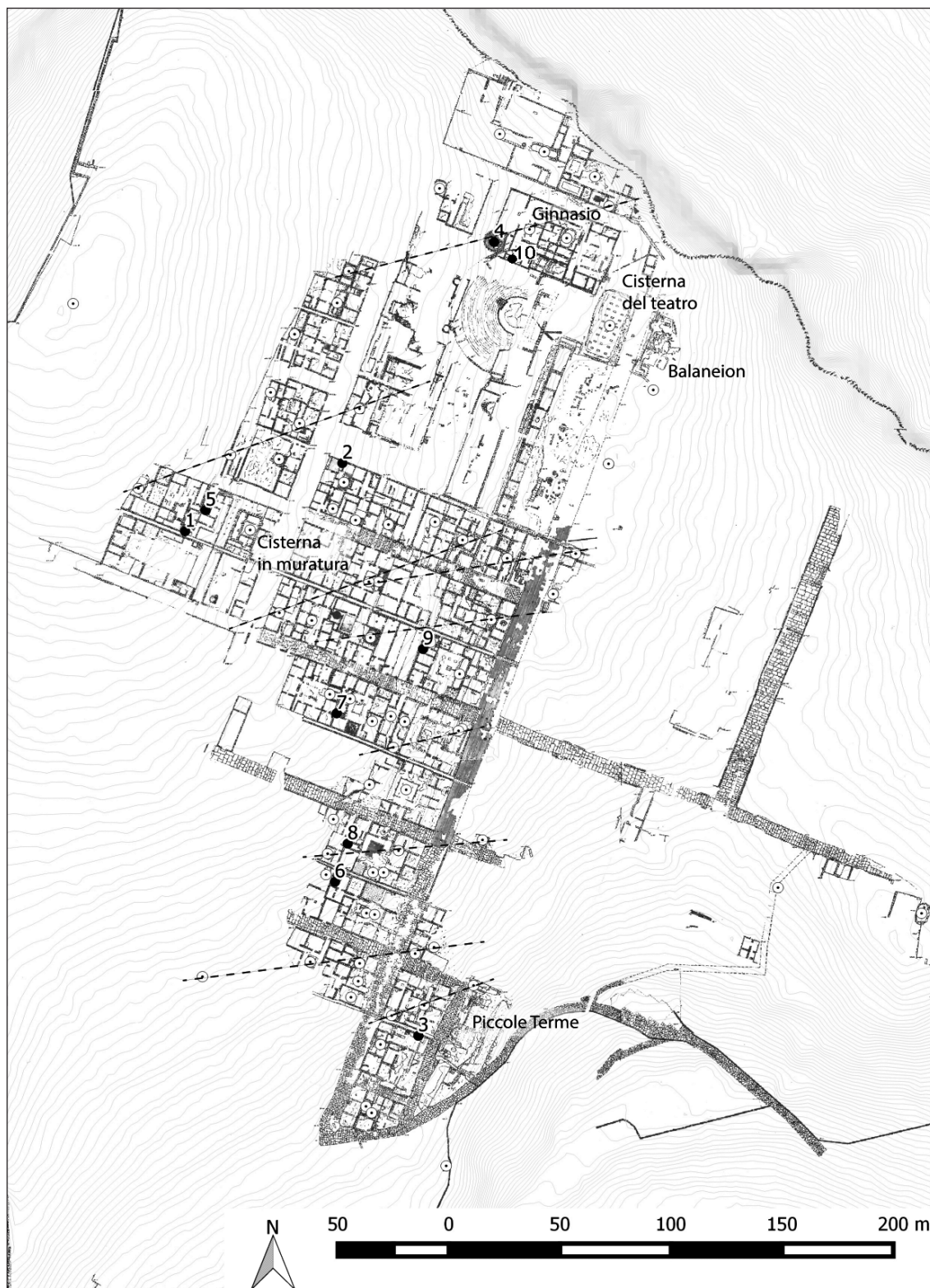
Fig. 1. Solunto, planimetria dell'abitato con la localizzazione delle cisterne e delle infrastrutture igienico sanitarie. Le linee tratteggiate riprendono l'andamento delle fratture del monte lungo le quali sono ricavate le cisterne.
