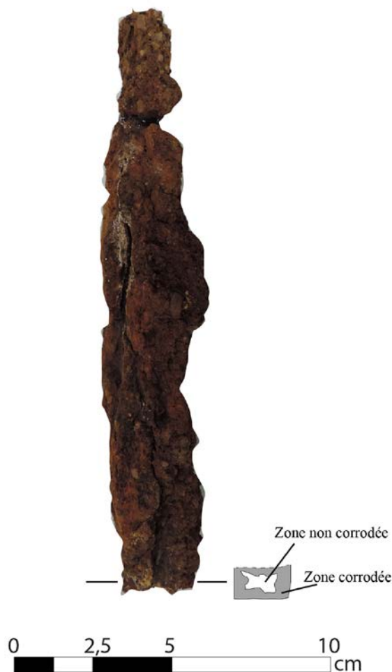
Fig. 6 : Métallographie d'une barre de fer : emplacement de la section observée © Guillaume Saint-Didier.
