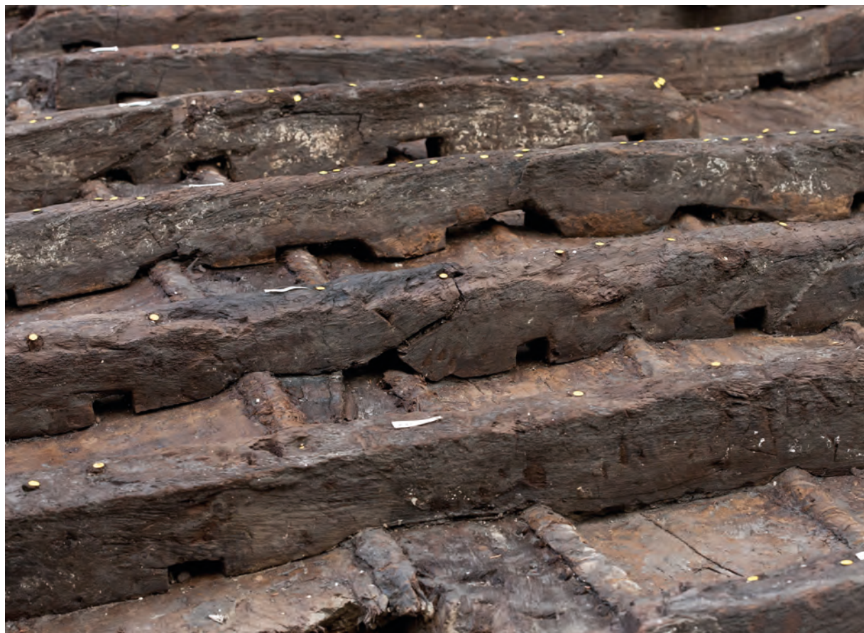
V.13 Pula 1 , pogled na rebra obrađena iznad šivanja Pula 1 , view of the frame crenellated to pass over the sewing (fotografija / photo by: T. Brajković)
