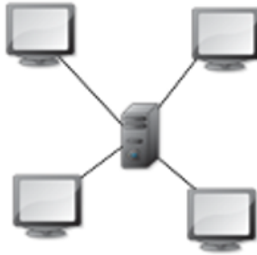
Figure 1 : Topologie de réseau en étoile. Source : Wikipedia, https://fr.wikipedia.org/wiki/Topologie_de_r%C3%A9seau
