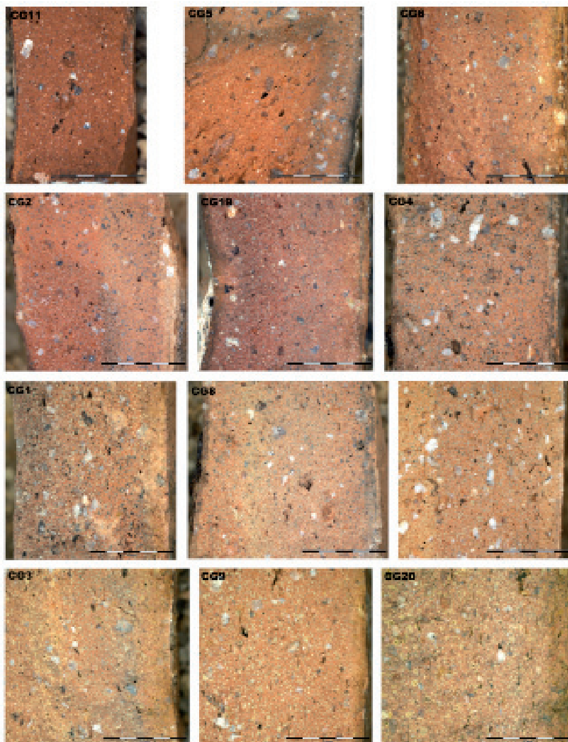
Figure 2 : Photographies des fractures fraîches de quelques exemplaires des amphores examinées au micro-stéréoscope, 10X (échelle : 5 mm).
