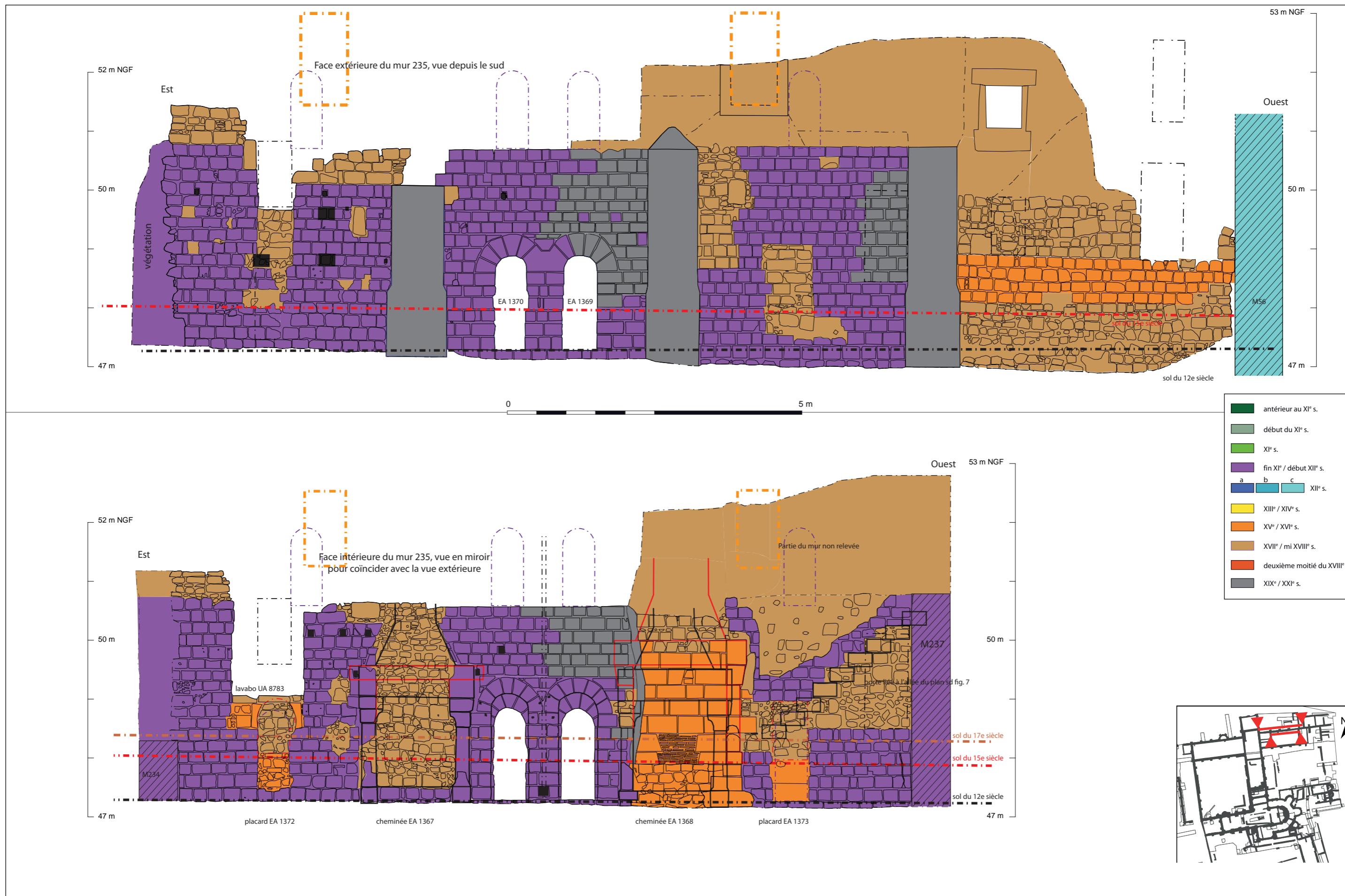
Planche 31 : analyse du bâti du mur gouttereau nord du « régulier » (M 235) (d'après le relevé de Bancaud, Body 2006, complété par Julien Noblet en 2010) – le parement interne est vu en miroir pour coïncider avec la vue extérieure
