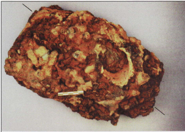
Pl. D. C. Dupuy, P. Fluzin, A. Ploquin, A. Durand et C. Rolando Situation du plan de coupe analysé et macrographie montrant l'embout de tuyère à 60°. Un fragment de loupe apparaît en blanc, 10 cm à gauche de la tuyère. La surface inférieure est courbe et constituée de cavités ouvertes représentant probablement des empreintes de charbons de bois. Cette morphologie implique l'existence d'un fond de four hémisphérique et l'emploi comme combustible de charbons de bois.
