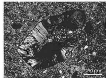
c) \mu 11.3, x100 (lumină polarizată analizată) exemplu de cristal hexagonal de sare observat în argilele verzii
