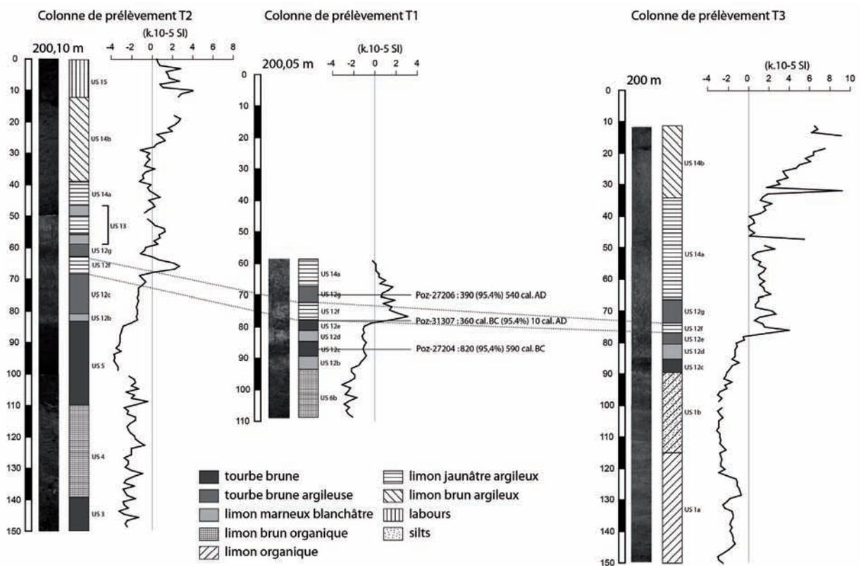
Figure 7. Colonnes T1, T2 et T3 de prélèvements sédimentaires sur la coupe de la tranchée 2 (de gauche à droite pour chaque colonne : profondeur en centimètre, photographies, lithologies, courbe de susceptibilité magnétique en  $k \cdot 10^{-5} \text{ SI}$ ) (illustration F. Cruz).
