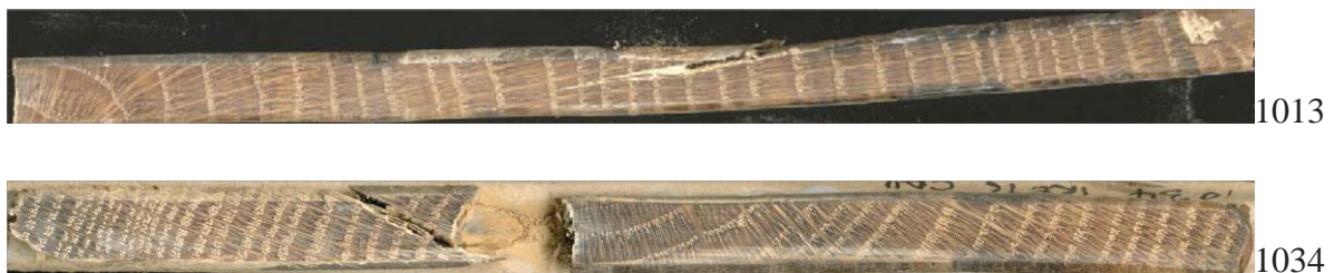
Figure 8 : Photographies des échantillons 1013 et 1034. 1034 est cassé et nous avons noté l'absence de cernes.
