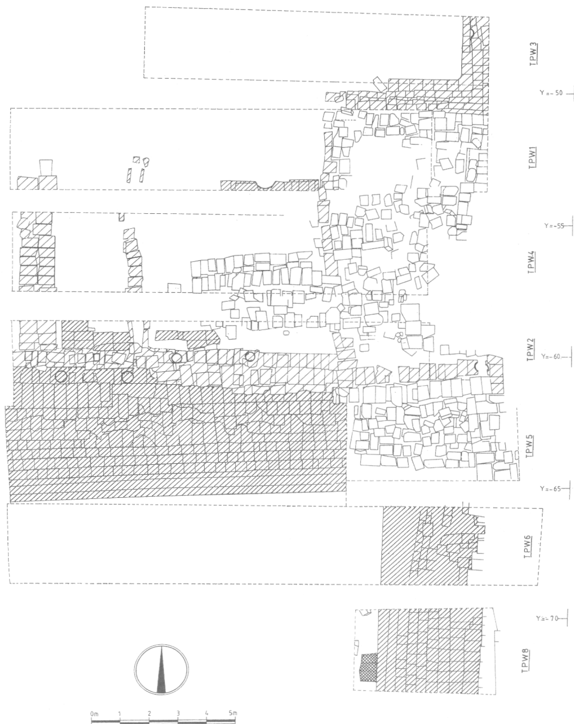
Planche 1: Plan d'ensemble des sondages et des structures dégagées sur la face ouest du perron nord de la terrasse des Éléphants. Quatre séquences d'aménagement: état 1, hachures croisées sombres; état 2, hachures sombres; état 3, hachures claires; état 4, blanc.
