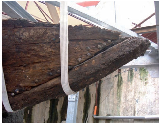
Fig. 14: Vue du côté tribord du brion d'étrave. L'assemblage des extrémités des virures dans la râblure est renforcé par une rangée de clous en alliage de cuivre (cliché G. Boetto).
