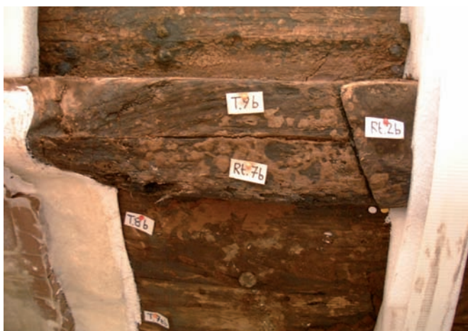
Fig. 36: Le romaillet Rt7b qui répare l'angle inférieur de la préceinte T19b. A droite de l'image, la doublure de la préceinte Rt2b (cliché G. Boetto).
