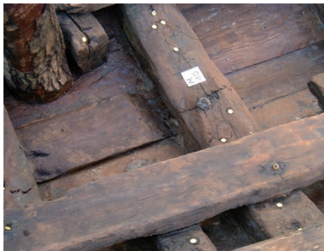
Fig. 16: Vue de la face supérieure de la varangue M10, traversée par la broche en alliage de cuivre qui renforce le trait de Jupiter entre la quille et le brion d'étambot (cliché G. Boetto).
