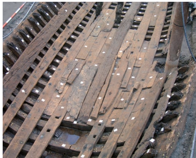
Fig. 12 : Les planches posées sur le vaigrage de part et d'autre de la carlingue/emplature du mât vues depuis l'arrière du bateau (cliché G. Boetto).
