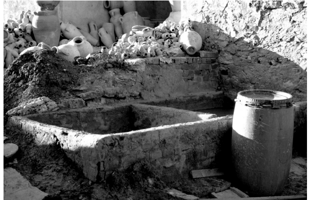
b : Délayage de l'argile à l'eau salée (Moknine, 2001)
