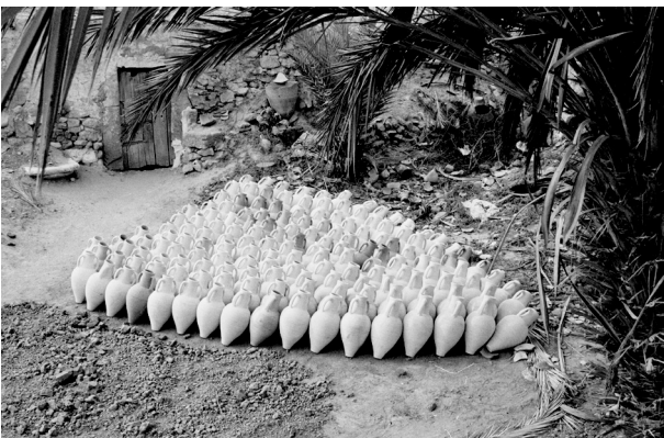
g : Poteries à surface blanche obtenues par délayage de l'argile à l'eau salée (Gallala, 1995)
