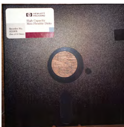
Illustration 8. Floppy disk : disquette 5.25 pouces
