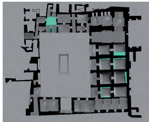
Fig. 4. Écarts constatés entre le plan fourni et les relevés supérieurs à 15 cm. Les écarts inférieurs à 15 cm ne sont pas ici indiqués.
