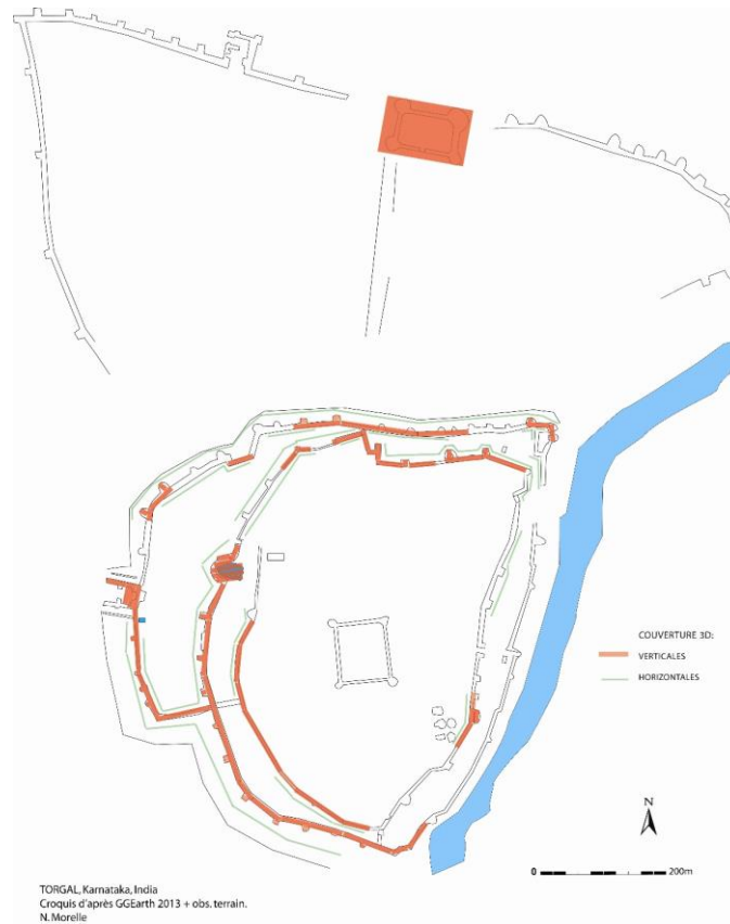
Figure 188 : la couverture 3D et le MNT n'a pas été globale, certaines zones difficiles d'accès ou cachées par la végétation s'ajoutent à l'orientation souhaitée pour la compréhension des vestiges (les zones couvertes en MNT sont en rouge, les zones couvertes en élévation 3D en vert)
