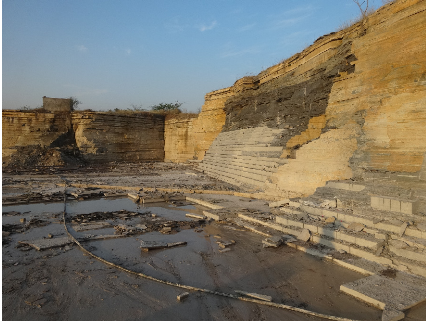
Figure 9 : exploitation par plaques de la carrière de Fartabad (à quelques kilomètres au nord de Firozâbâd, proche de Shahabad)
