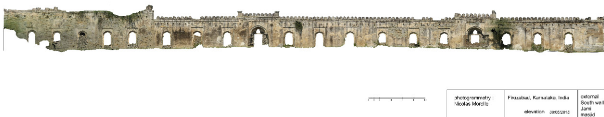
Figure 104 : orthophotographie de la façade sud de la mosquée
