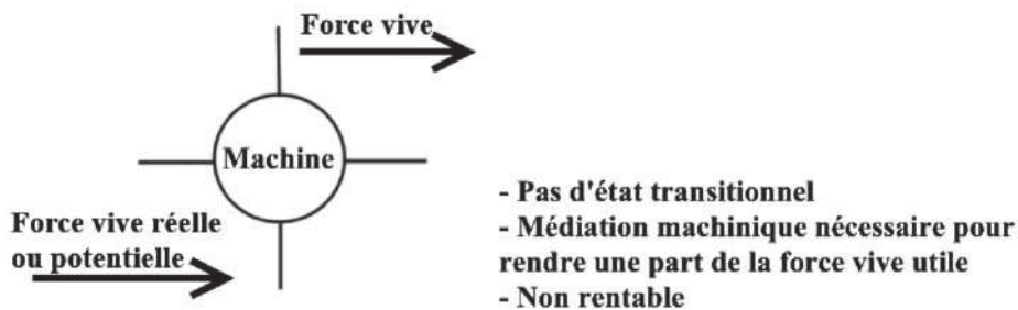
Fig. 7 – Si la force vive est apportée par un agent non organique, elle est directement, bien qu'imparfaitement, utilisée par la machine et ne subit aucune espèce de conversion.
