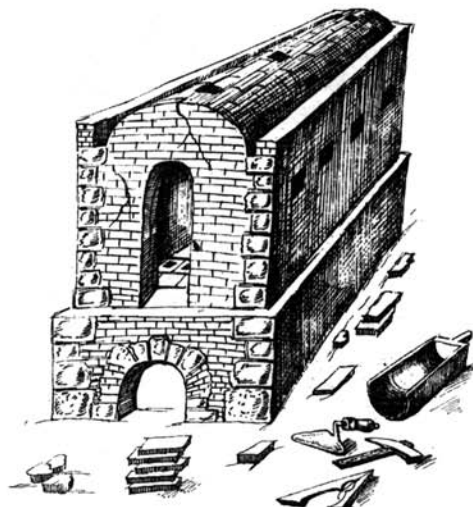
Fig.2 : Four à cuire le biscuit (Piccolpasso, Conti 1976).
