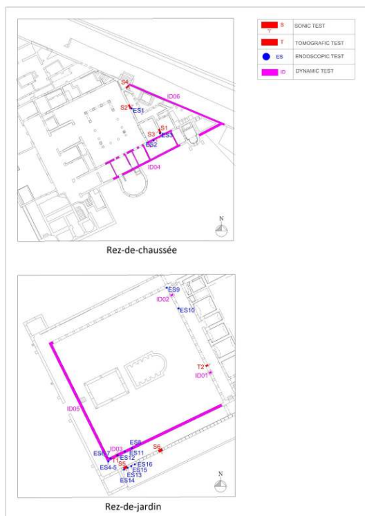
Fig. 12 – Emplacement des tests ingénieriques.
