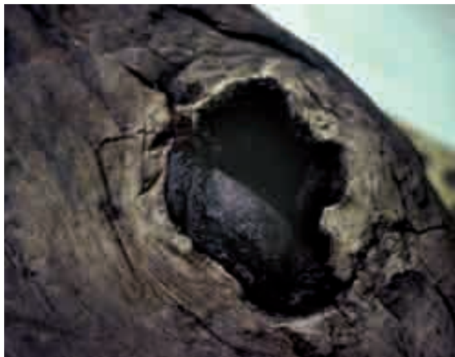
Fig. 13. Bouchon d'étoupe à base de tissu poissé dans un nœud (photo É. Rieth).
