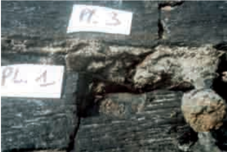
Fig. 3. Chaland de Chalon-sur-Saône : clou tangentiel et mortaise à la jonction de Pl. 1 et Pl. 3 (cliché Musée Denon, Chalon-sur-Saône).
