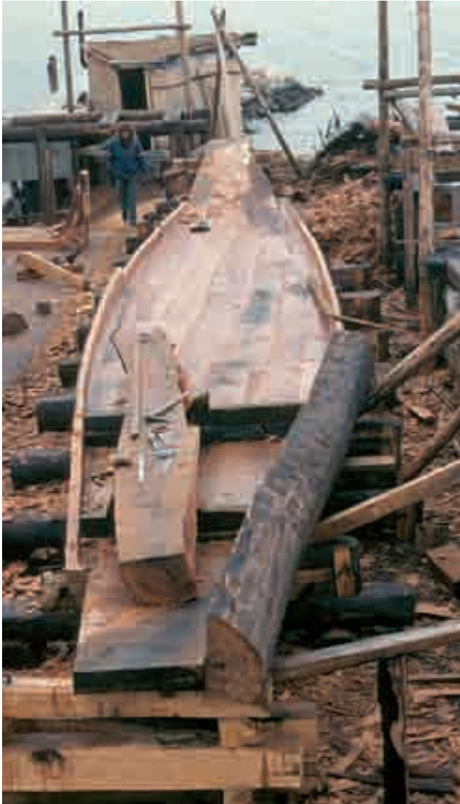
Fig. 11. Installation de deux demi troncs sur le sommet des bordages de transition au niveau de la poupe d' Altaripa . Façonnés par réduction, ils assumeront la liaison entre la sole et les flancs au niveau des extrémités. On les appellera les cuillères (photo BÉAT ARNOLD).
