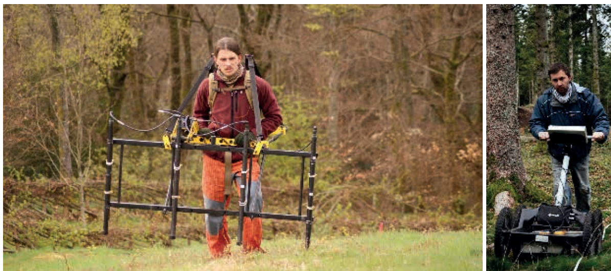
14. Bibracte, Mont Beuvray. Les prospections géophysiques. L'appareillage utilisé. Magnétomètre fluxgate Ferex (marque Foerster, Allemagne) et géoradar RAMAC X3M (marque Malå GeoScience, Suède).
