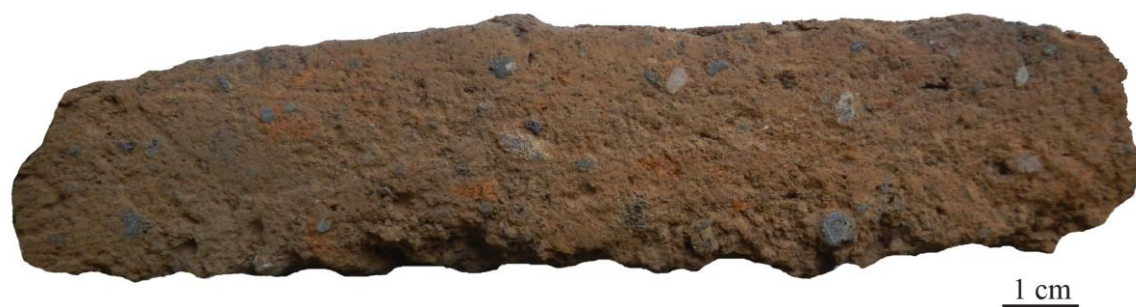
Fig. 14. Mursia, Pantelleria (TP), scavi UNIBO. Campione di piano pavimentale (US 1226): struttura microgranulare composta da aggregati fortemente coalescenti, localmente tendente al massivo. Tessitura eterogenea limo-sabbiosa, con sabbie grossolane e ghiaie fini. Possibile impasto piuttosto curato allo stato fangoso, con messa in opera allo stato fangoso (o eventualmente plastico?).
