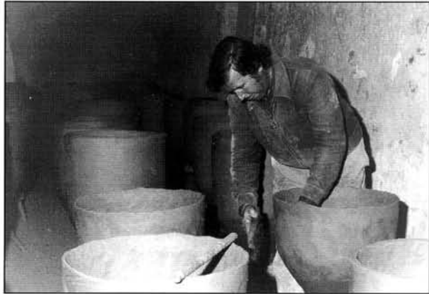
Figure 21 Gestes et outils traditionnels, une jauge (bâton) et une palette employés dans la fabrication des jarres à Colmenar en Espagne en 1978
