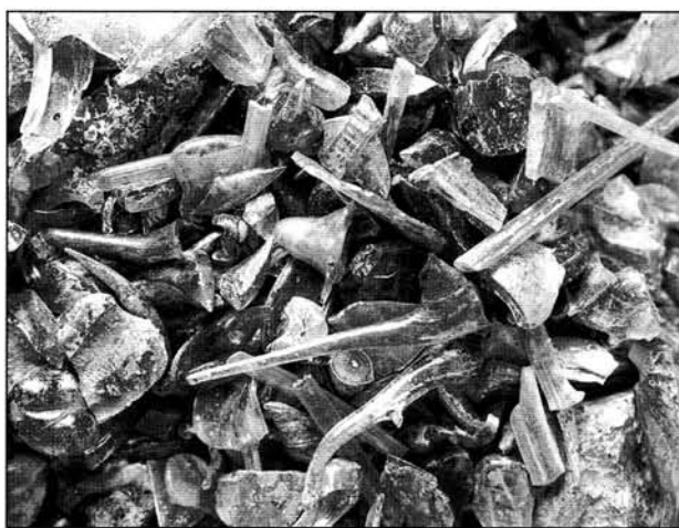
Figure 28 Déchets de verre du four de Cadrix: baguettes, fils, larmes (avec marques des pinces) et mors (verre resté collé sur la canne après le détachement de l'objet fini)
