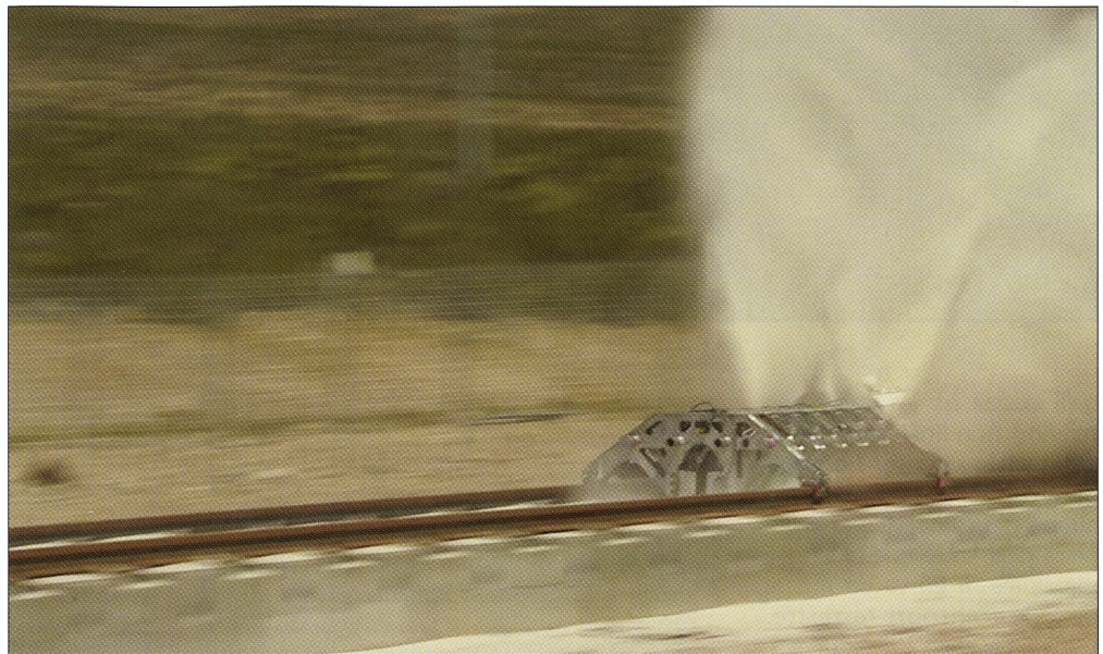
En quelques secondes à peine, un traîneau monté sur des patins métalliques posés sur deux rails a été lancé à 640 km/h avant d'être freiné par du sable
