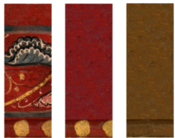
Etat 1 : Polychromie originale - Etat 2 : Premier repeint (partiel) - Etat 3 : Deuxième repeint en badigeon
