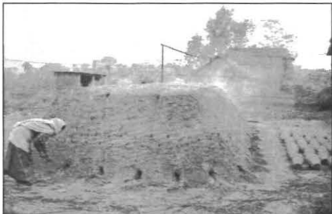
I 3. Disposition de la charge à cuire et cuisson chez les Kuma de Thimi
